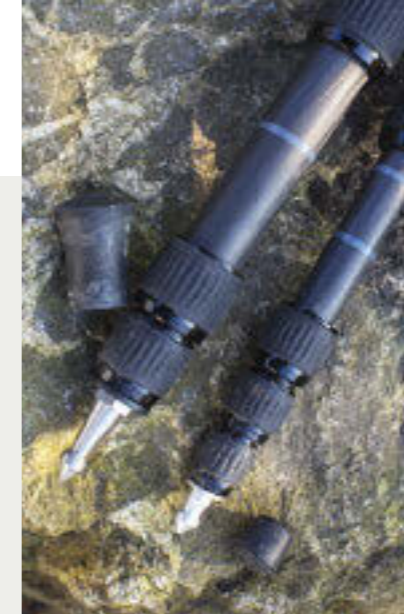
Praktische Details: Die Gummifüße der Stativbeine lassen sich einfach abziehen und dann stehen – beispielsweise auf vereisten Böden – solide Spikes zur Verfügung. Der jeweils oberste Beinauszug verfügt im Abstand von 5 cm über Markierungsringe, die es einfacher machen, die Beine schnell auf gleiche Höhe auszuziehen.
