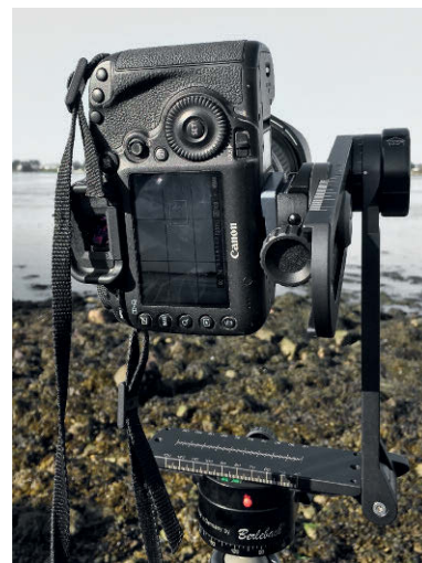
Der Berlebach-Nodalpunktadapter zusammen mit der Panoramabasis P103 im Einsatz. Bevor es „erst“ wird, sollte man für die verwendeten Objektive die jeweiligen Nodalpunkte ermittelt haben. Insbesondere bei Weitwinkelbrennweiten und bei Motiven mit großer Tiefe ist das essentiell, während man bei Teleaufnahmen durchaus etwas hemdsärmeliger vorgehen kann. Die auch bei schlechten Lichtverhältnissen gut ablesbaren, jeweils beidseitig eingravierten Skalen machen es einfach, die Kamera präzise zu justieren.
