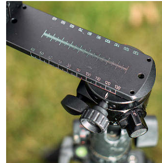
Die lasergravierte Skala auf der Oberseite der X-Schiene erleichtert das Einjustieren der Kamera. Die Feststellschrauben der Schnellkupplung sind üppig dimensioniert und lassen sich so auch mit dicken Handschuhen ziemlich problemlos bedienen. Das gilt auch für den Schalter, mit dem sich die Drehwinkel einstellen lassen.
