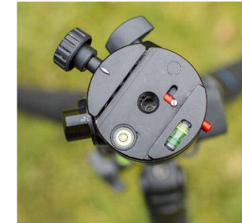
Blick von oben auf die Panoramabasis P103. Deutlich erkennt man den roten Sicherungspin, der in Verbindung mit den Berlebach-Wechselplatten zuverlässig verhindert, dass die Kamera bei nicht ganz fixierter Feststellschraube herausrutscht. Links befindet sich der Schalter, mit dem man die Schrittweite der Drehung einstellt (15°, 18°, 24° und stufenlos). Verfügt man nicht über ein Stativ, wie etwa ein Berlebach Report mit einer mit Libelle ausgestatteten Basis (Bild rechts), muss man den Kopf nivellieren, bevor man den Nodalpunktadapter in die Schnellkupplung einschiebt, da dann die Dosenlibelle von der X-Schiene des Adapters verdeckt wird.
