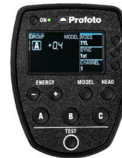
Die Air Remote C/N ermöglicht den drahtlosen TTL-Betrieb. Es ist schon sehr komfortabel, dass man über die Fernsteuerung die Helligkeit der Blitze und des Einstelllichts sowie einzelne Blitze bzw. Blitz-Gruppen an- oder ausschalten kann, ohne dafür vom Gerät zu Gerät laufen zu müssen.
